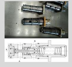
伸缩平衡阀可靠性提升,仅需 1处金属密封,内泄量小,密 封性能提升60%以上,安全性 更高。
